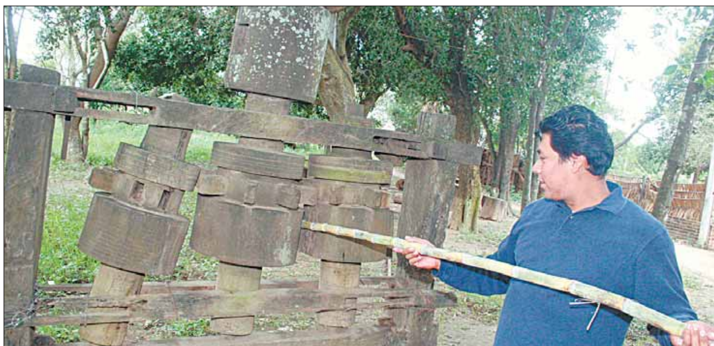
El trapiche de madera para sacar la melaza de la caña de azúcar fue reemplazado por las máquinas de vapor en los años 30
